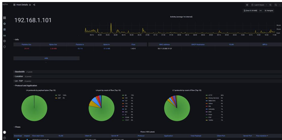
每次点击 IP 地址时，都会显示 "主机详细信息" 面板。该控制面板可深入分析特定于过滤 IP 的网络活动，以及用于分析基于地理位置、TCP 数据、协议和应用程序信息以及流量的网络问题的所有指标。
