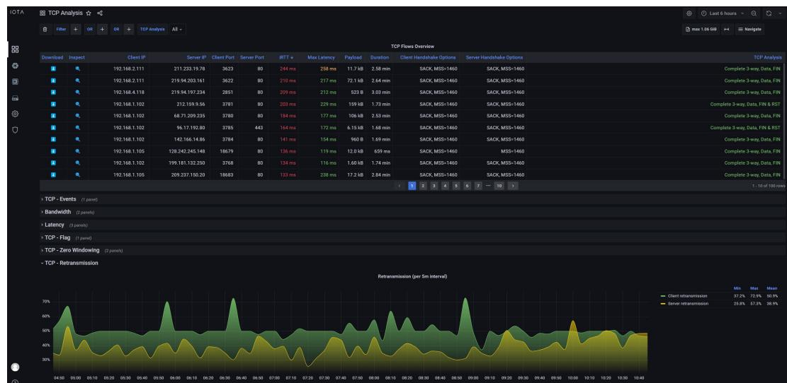
该仪表板提供与 TCP 相关的统计信息概览，如客户端 IP、服务器 IP、主机名、iRTT 以及更多信息，如 TCP 连接完整性分析。有多种图表可供选择，从不同角度显示 TCP 流量，并提供 TCP 协议的全面诊断。
