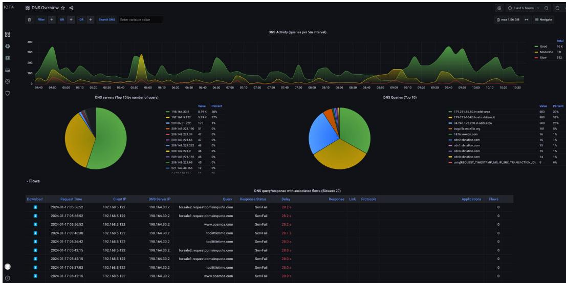
DNS 概览仪表板可让您概览一段时间内的 DNS 查询、顶级服务器以及按类型划分的顶级查询。
