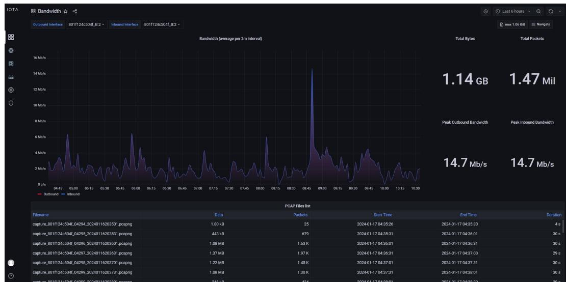
带宽仪表板提供在 IOTA 接口上测量到的流量带宽概览。仪表板会自动选择入站和出站两个接口，并在图表中分别显示每个接口的带宽数据。
