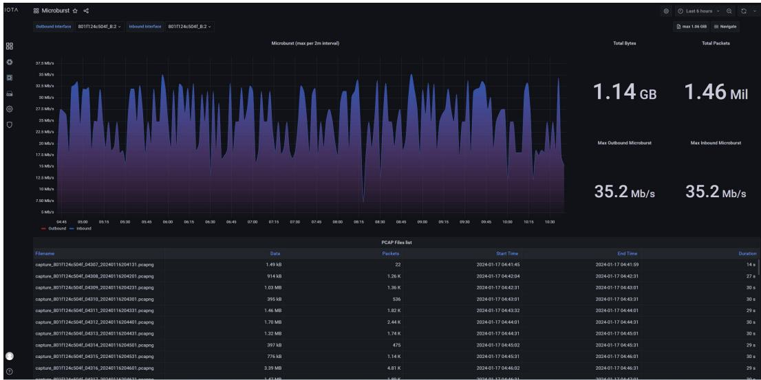
微爆仪表板提供在 IOTA 接口上测量到的流量微爆概览。仪表板会自动选择入站和出站两个接口，并在图表中分别显示每个接口的微爆数据。
