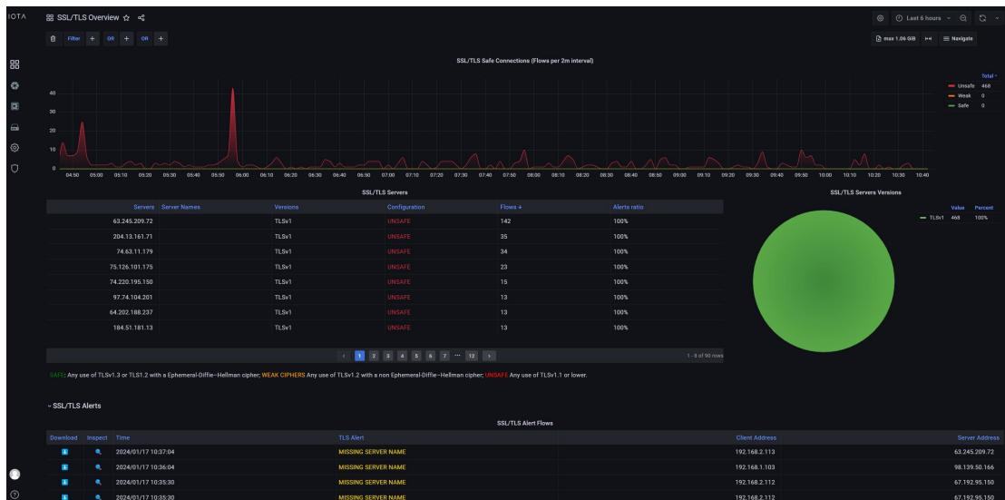
该仪表板提供 TLS 加密连接的概览，并根据所使用的 TLS 版本和密码，说明这些连接是安全的、弱的还是不安全的。可以对连接信息进行排序和过滤，以便直观地显示和识别可能存在问题的连接。
